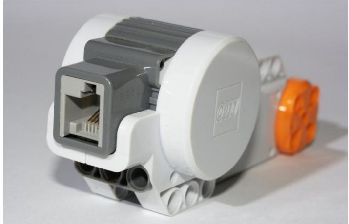
Abb. 2: NXT-Motor mit Drehsensor
