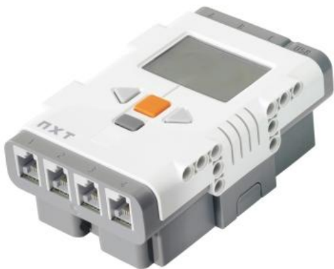
Abb. 1: NXT-Block, die zentrale Steuerung des Roboters
